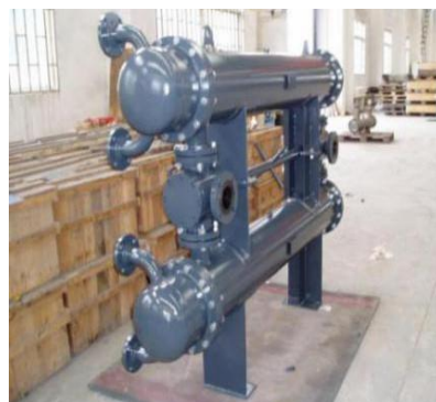
双联可切换式油冷器 Switchable double oil cooler
